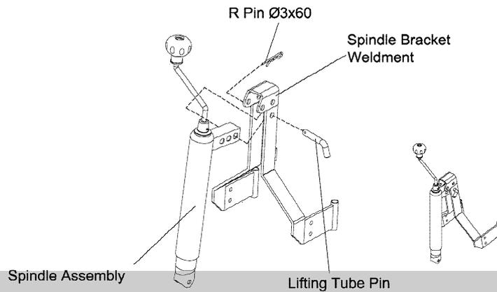
2) Spindelbøjle (27) og spindel (17) forbindes med split M10x 40(8). Sikres med hårnålesplit Ø2x47(7).
