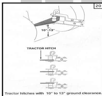
Abbildung 20: (Traktor Höhe 25-32 cm über dem Boden)
