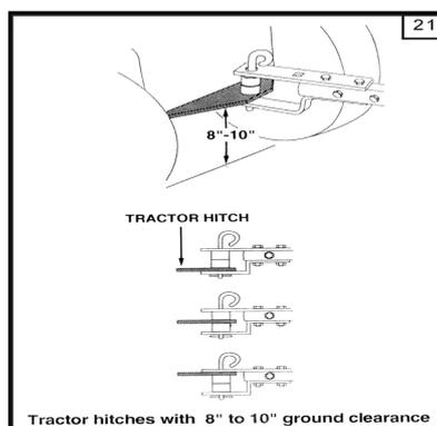
Abbildung 21: (Traktor Höhe 20-25 cm über dem Boden)
